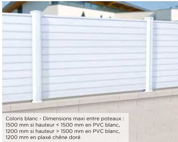
Coloris blanc - Dimensions maxi entre poteaux : 1500 mm si hauteur < 1500 mm en PVC blanc, 1200 mm si hauteur > 1500 mm en PVC blanc, 1200 mm en plaxé chêne doré
